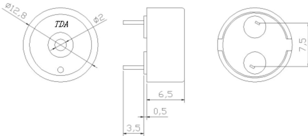
**Unit:mm Tolerance :  $\pm 0.5$ mm**
