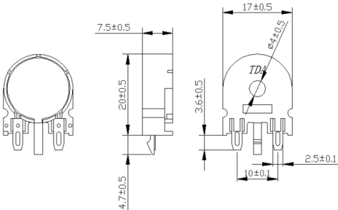
Unit:mm Tolerance :  $\pm 0.5$ mm
