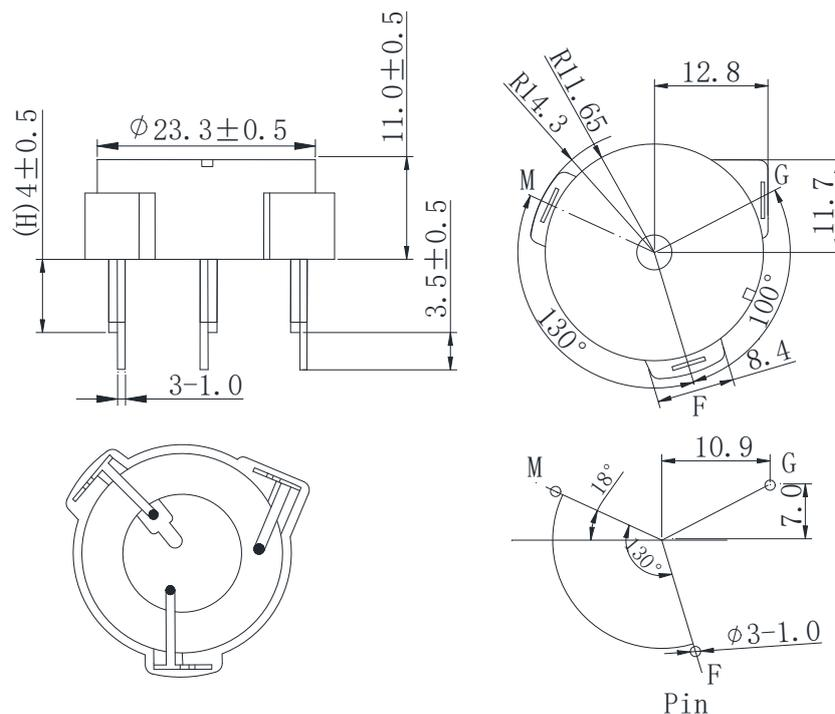
Unit:mm Tolerance :  $\pm 0.5$ mm
