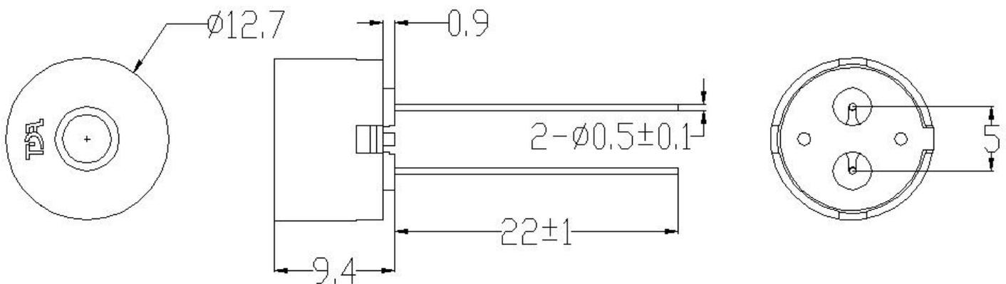
**Unit:mm Tolerance :  $\pm 0.5$ mm**
